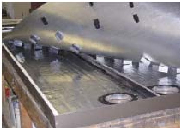
При отогнутой пластине поглотителя можно увидеть deflectоры в воздушной камере коллектора с пропуском по задней стенке.
